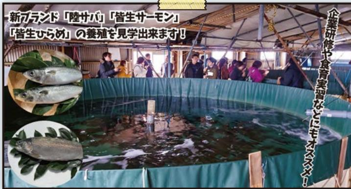
30トンの水槽が18基ある陸上屋内施設で「陸サバ」「皆生ひらめ」「皆生サーモン」を養殖。地下10メートルよりくみ上げた自然ろ過された海水を使用しています。
